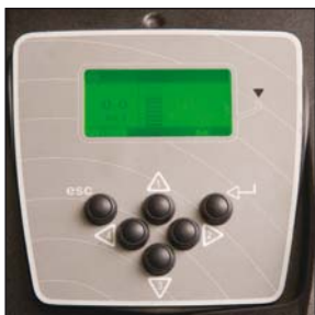
Indicador y preselector opcional de altura de elevación (PBV20ND)
