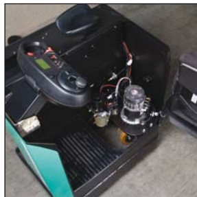
Puerta abatible de acceso a servicio
