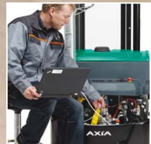
Acceso rápido para mantenimiento
